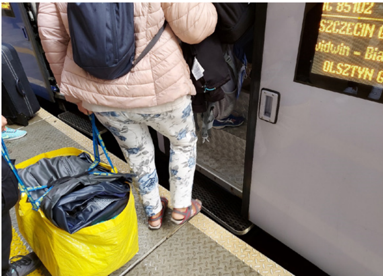
Rysunek 59. Schody przy wejściu do zmodernizowanego standardowego wagonu na peronie na dworcu Szczecin Główny Fot. materiały własne.
