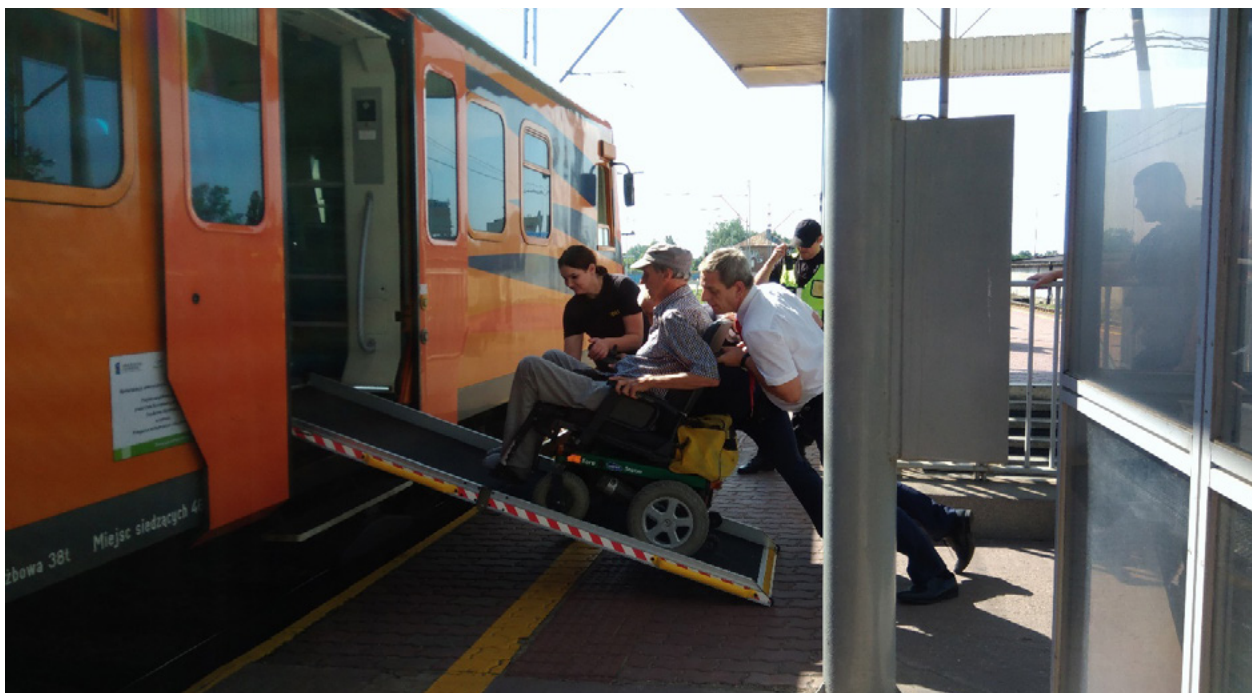
Rysunek 66. Wprowadzanie pasażera przy zbyt wysokim kącie nachylenia rampy na dworcu Łódź Kaliska
