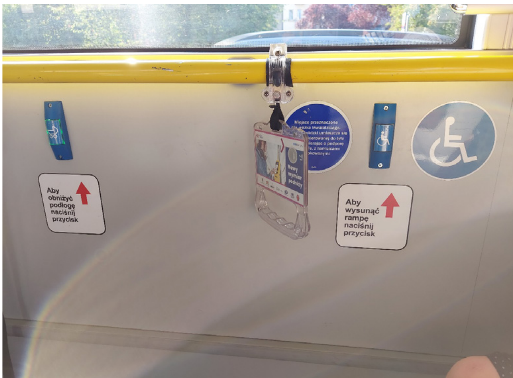
Rysunek 65. Oznakowanie wewnątrz pojazdów Trollino – poinformowanie kierowcy o konieczności zastosowania przykłąku lub wysunięcia rampy przez pasażera znajdującego się wewnątrz pojazdu, Gdynia
