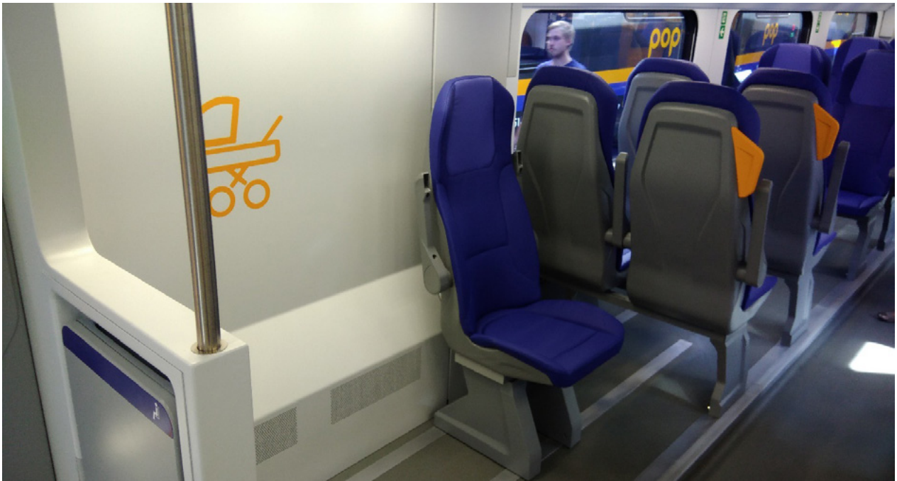
Rysunek 73. Miejsce dla nieskładanego wózka w pociągu Caravaggio Hitach dla Trenitalia (Włochy)
