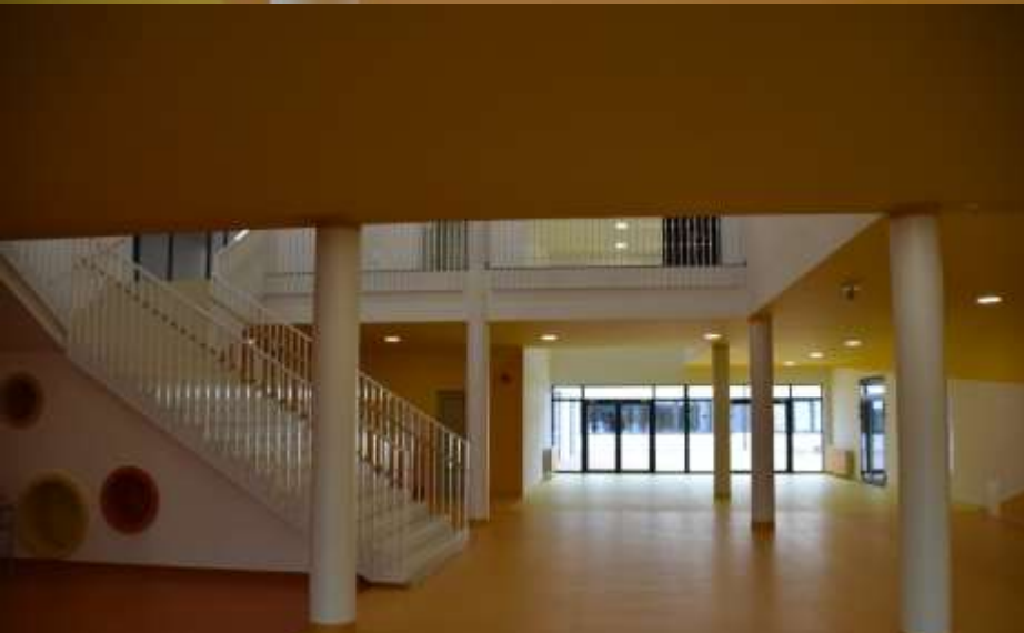
Hall główny z sufitem akustycznym ograniczającym odczuwalny poziom hałasu
